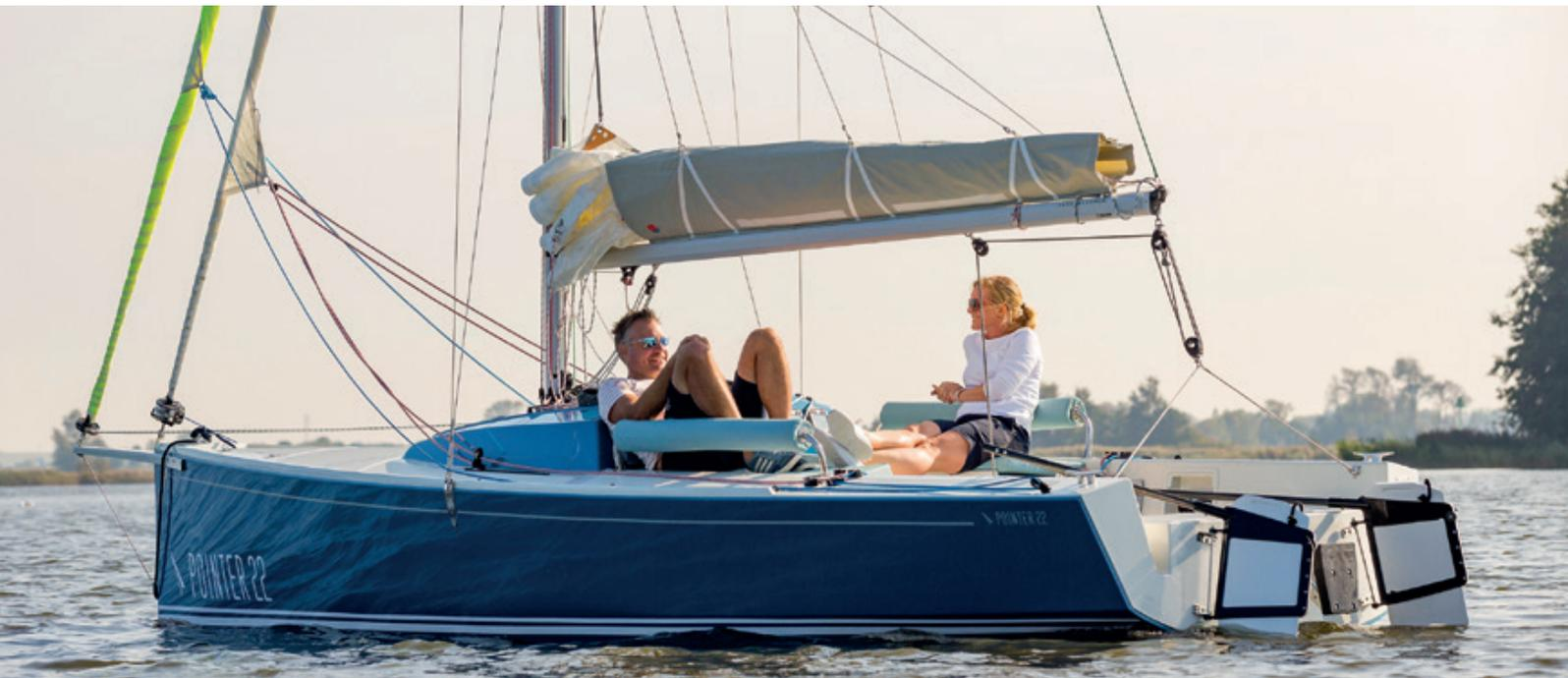
Durch den Hubkiel ist die POINTER 22 sehr gut trailerbar. Der Mast lässt sich einfach stellen oder legen. Der Tiefgang variiert von 0,30 bis 1,10 Meter. Das Schiff ist für Binnengewässer ebenso geeignet, wie für die Küste. Auch im Watt fühlt sich die Pointer dank geringem Tiefgang und der Möglichkeit zum aufrechten Trockenfallen wie zuhause.
